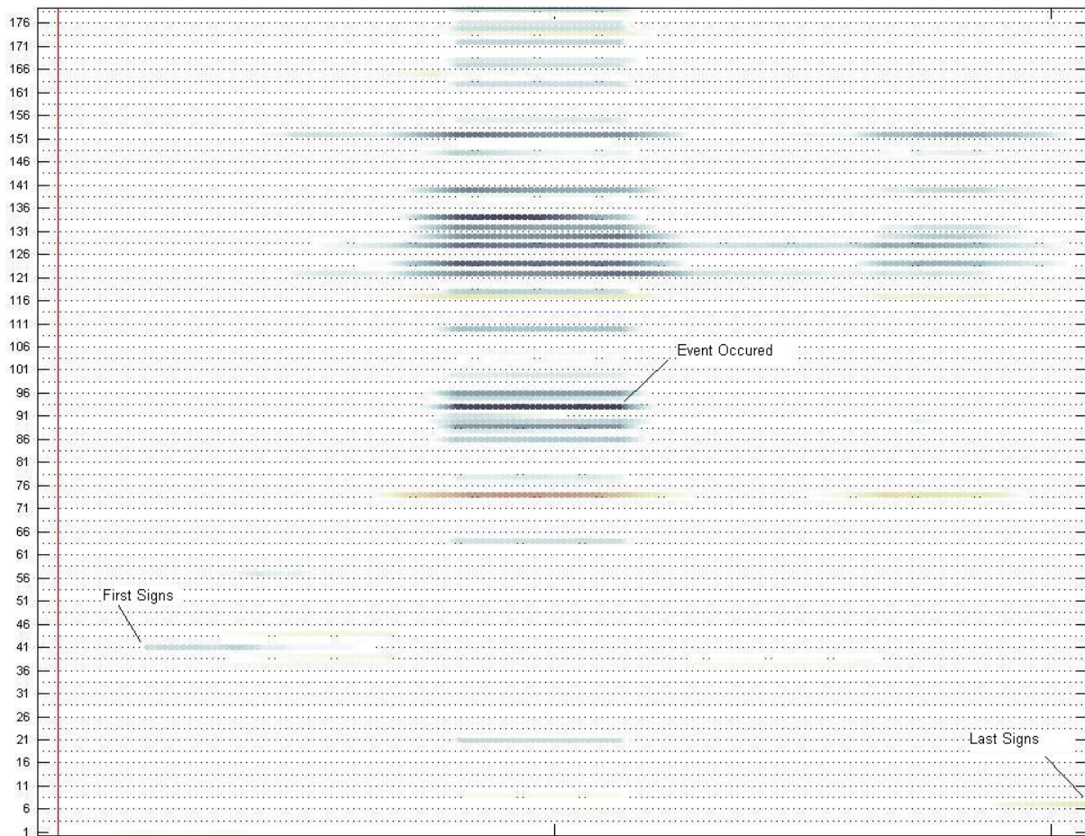
Schaubild 1: Die senkrechte Achse zeigt die Sensoren, die analysiert werden, sodass das Bild als Ganzes uns eine holistische Zustandsbeschreibung der ganzen Turbine ermöglicht. Wir können dem Ausdruck entnehmen, dass ein Ereignis zunächst von Sensor 41 angezeigt wird, bevor eine noch gravierendere Abweichung bei den Sensoren 122 und 151 zu beobachten ist; danach machen sich weitere Sensoren bemerkbar. Die größte Anomalie zeigt sich bei Sensor 93. Über den Zeitraum von mehreren Tagen scheinen die Anomalien der meisten Sensoren wieder zu verschwinden, sodass vor nur noch (vor allem) an den Sensoren 122 und 151 weiterhin Abweichungen festzustellen sind. Diese Abweichungen stellen somit eine sekundäre Reaktion von schwächerer Größenordnung dar. Schlussendlich verschwinden dann doch alle Anomalien.
